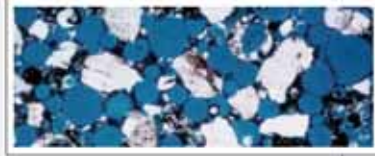
Microfotografia (su sezione sottile e con tracciante blu) che evidenzia la regolare distribuzione e dimensione dei macropori
